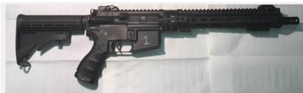
Arma de autodefensa de tripulaciones [Aircrew Self Defense Weapon (ASDW)] del Ejército del Aire estadounidense con empuñadura abatible, cañón desmontable, guardamanos MLOK y elementos de puntería de respeto abatibles (Foto del Ejército del Aire estadounidense).
